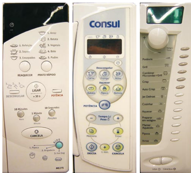
[figura 02] Painéis de comandos de forno de microondas Electrolux, Consul e Brastemp (BRASIL, 2002).
