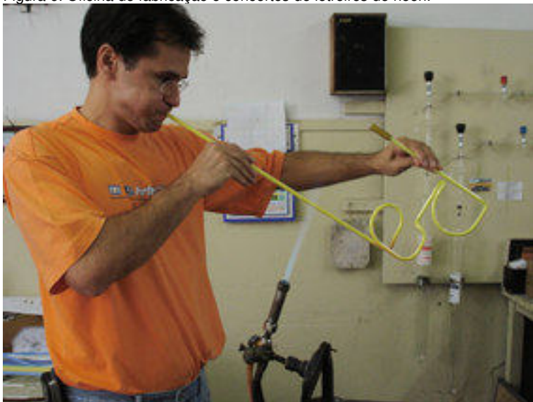
Figura 7: Técnica de fabricação do luminoso de néon.
