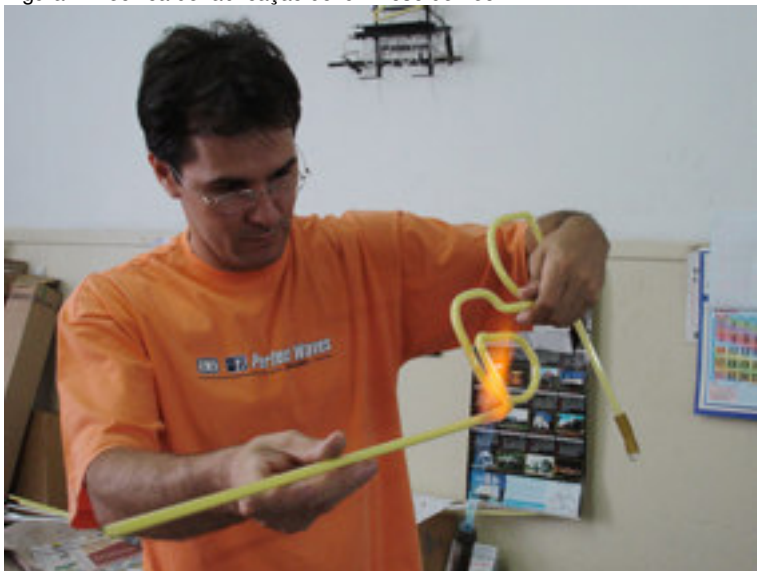
Figura 7: Técnica de fabricação do luminoso de néon.
